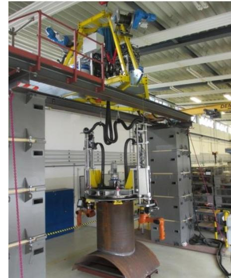
Laboraufbau der Rohrknottenschweißanlage
