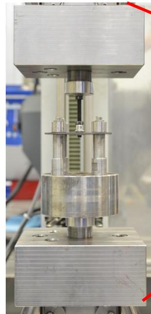
Dauerschwingversuch an Blindnietmuttern
