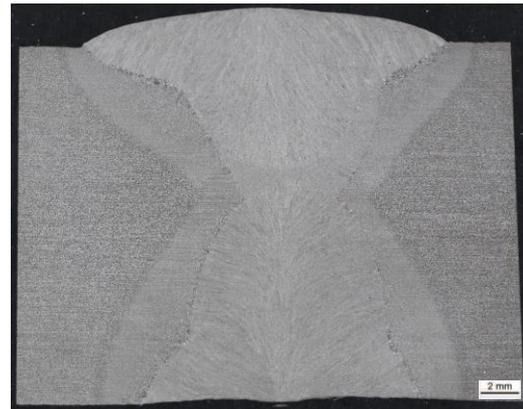
Makroschliff einer Schweißnaht
