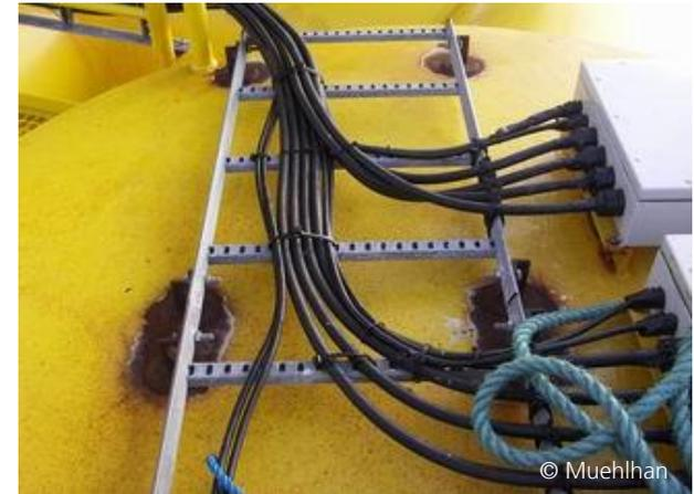
Beispiel für Schäden an Beschichtungen durch geschweißte Halterungen im Offshorebereich
