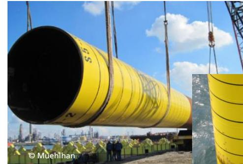
Schädigungen in Folge von Druckbeanspruchung beim Transport
