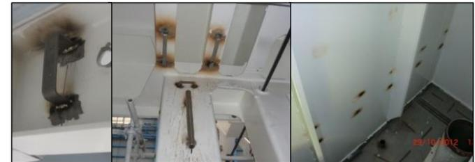
Großflächige Beschichtungsschäden beim Schweißen durch hohen Wärmeeintrag an Haltern und auf der Rückwand
