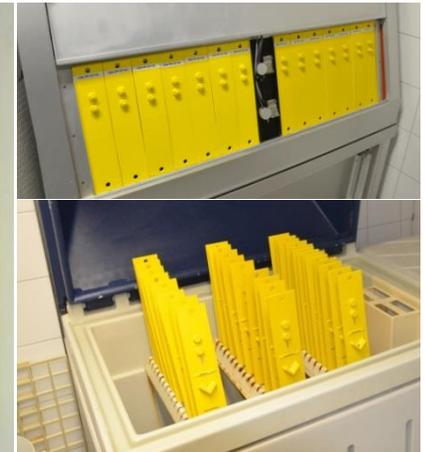
Komplexe Prüfkörper mit versch. Beschichtungssystemen während der UV-Kondensationsbeanspruchung und im Salzsprühnebeltest
