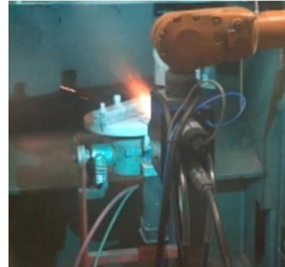
Lichtbogenspritzversuch zur Optimierung der Prozessparameter und Werkstoffeigenschaften
