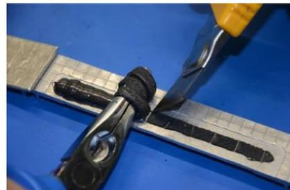
Zugscherfestigkeitsversuche an GFK-Proben bei Tieftemperaturen
