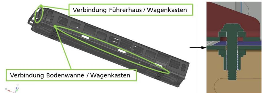
Reibschlüssige Langlochverbindung im Schienenfahrzeugbau
